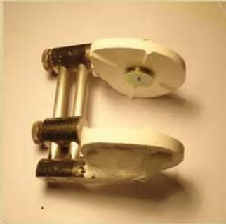
Articulador con brazos deslizantes. Desatornillando el tornillo superior, podemos separar los modelos del aparato de sujeción y volverlos a colocar en la misma posición exacta, sin dañarlos. La guía, cortada en cola de milano es precisa, y evita que el brazo fijador se tuerza.
